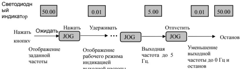
Рис.4-9 Пример управления в толчковом режиме
