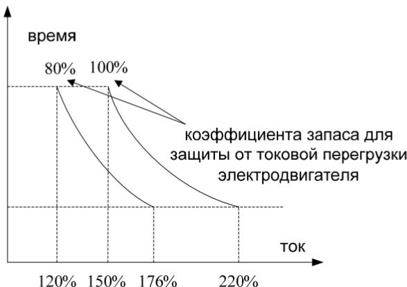
Рис. 6-31 Задание коэффициента запаса для защиты от токовой перегрузки
