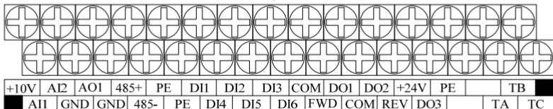
Рис. 3-7 Расположение клемм на пульте управления
