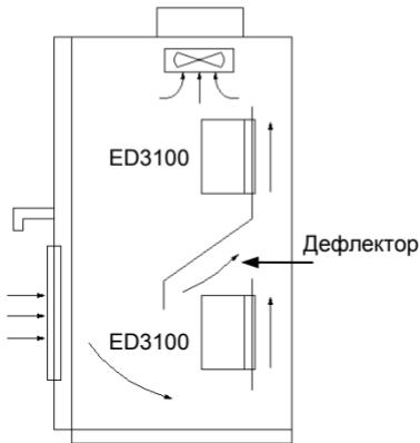
Рис. 3-2 Установка нескольких преобразователей
