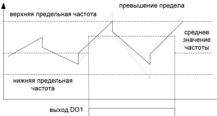
Таблица 6-15 Предел флюктуации качающейся частоты
