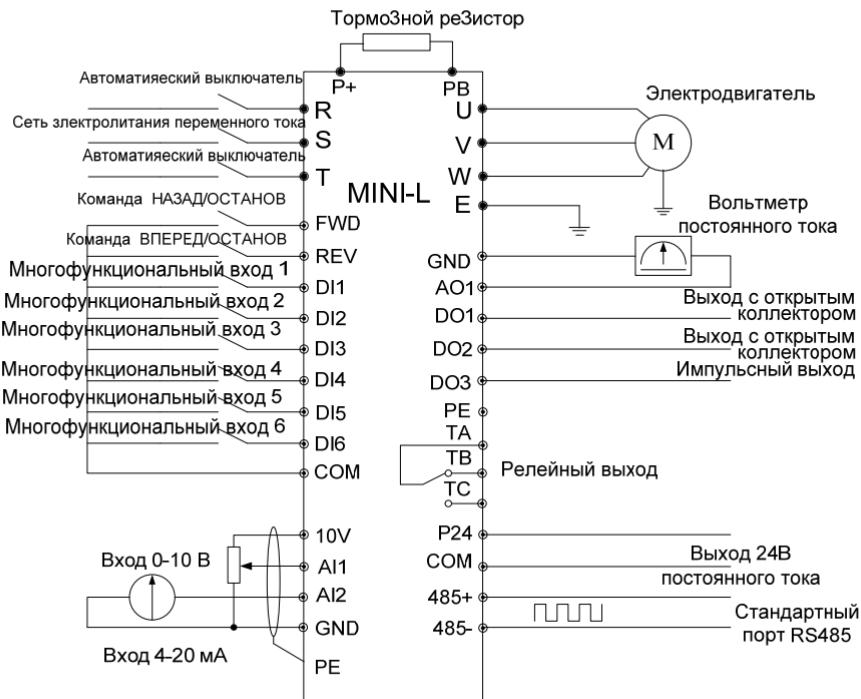
Рисунок 3-7 Подключение для баз
