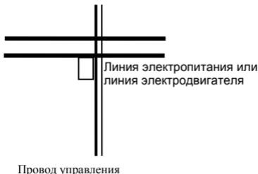
Рис. 3-14 Требования к прокладке проводов
