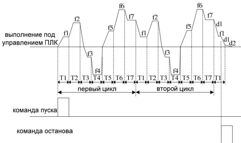
Рис. 6-27 Непрерывный цикл
