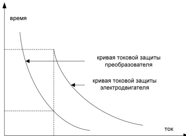
Рис. 6-30 Кривые срабатывания токовой защиты преобразователя и электродвигателя
