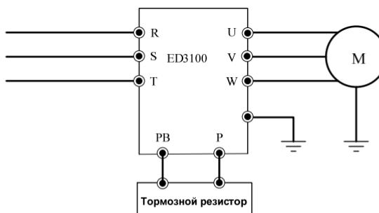
Рис. 2-1 Подключение тормозного блока к преобразователю
