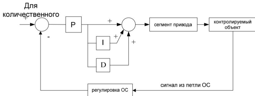
Рис. 6-21 Работа ПИД-регулятора
