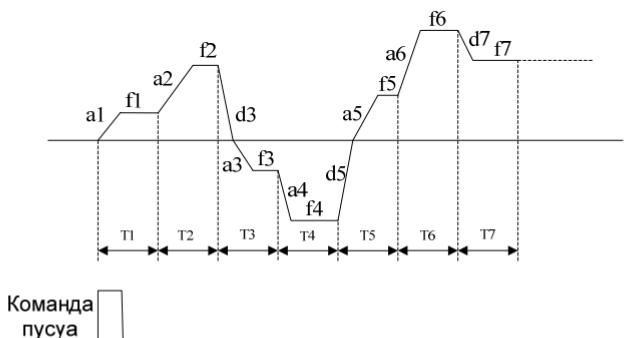
Рис. 6-28 Удерживание конечного значения после одиночного цикла
