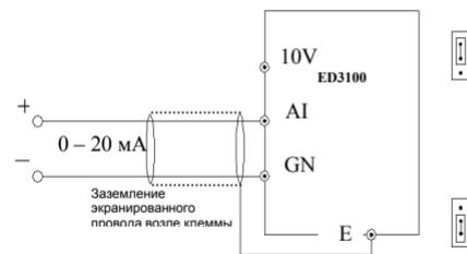
Рис. 3-9 Подключение к клемме AI2
