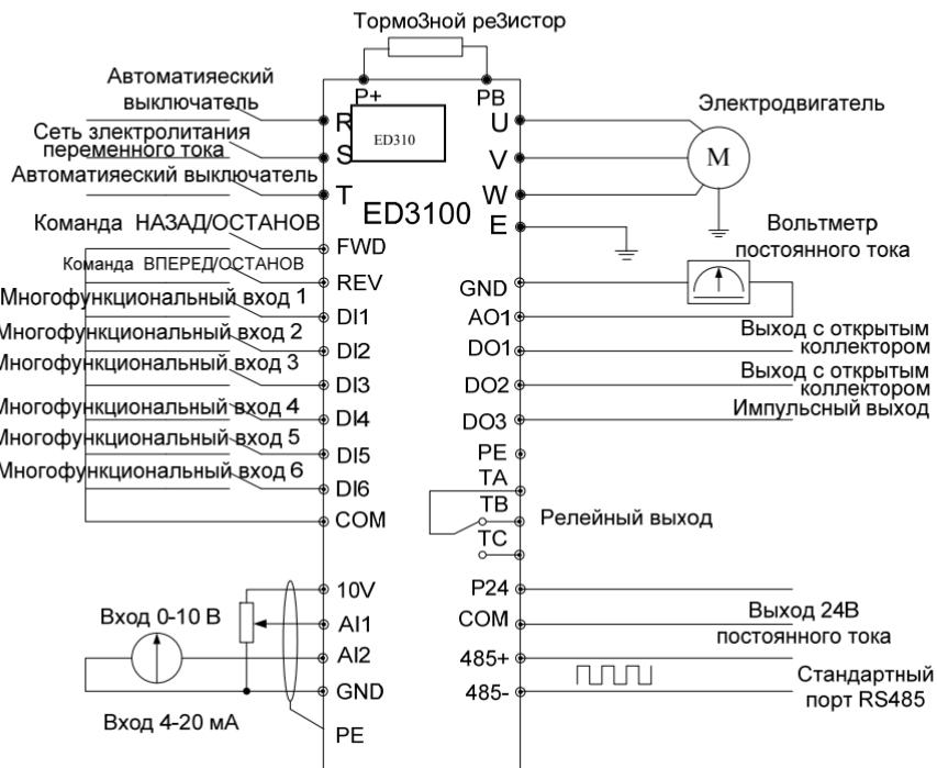
Рис. 3-5 Типовая схема электрических соединений для преобразователей
