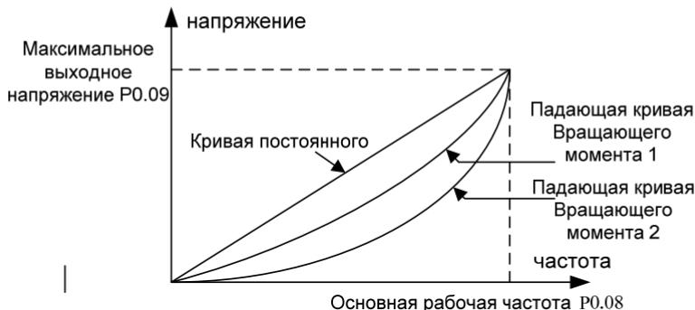
Рис. 6-4 Вольт-частотная кривая
