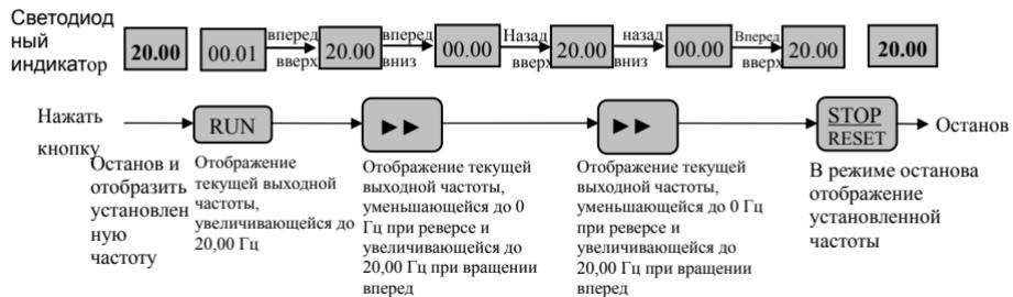
Рис.4-10 Пример переключения между пуском, остановом вращением вперед
