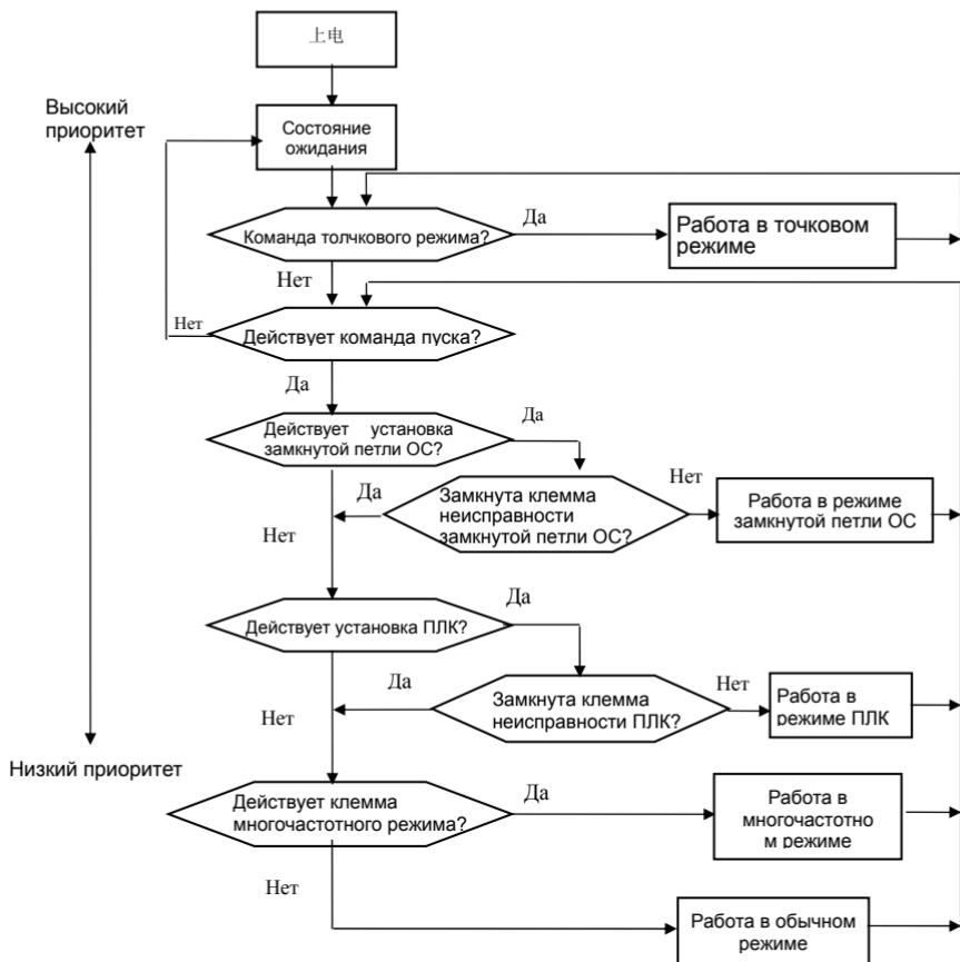
Рис. 4-1 Логическая диаграмма рабочих состояний преобразователя серии ED3100
