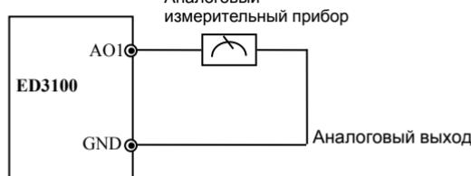
Рис.3-10 Подключение к клемме аналогового выхода
