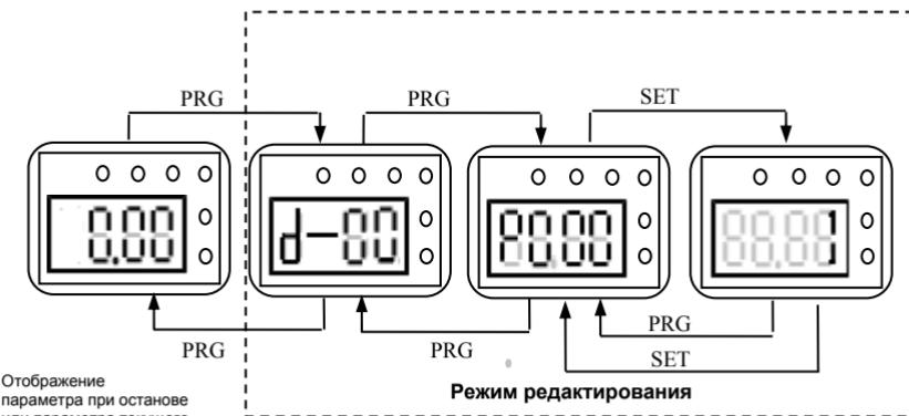
Рис. 4-6 Режим программирования пульта управления
