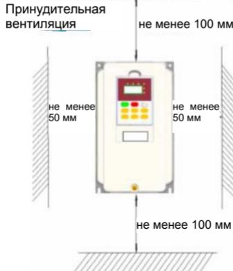
Рис. 3-1 Пространство, требующееся для установки преобразователя
