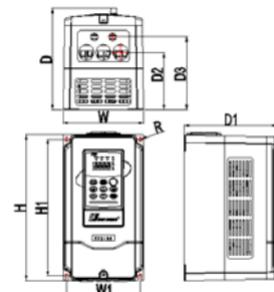
б): мощностью 0,75кВт~4,0кВт
