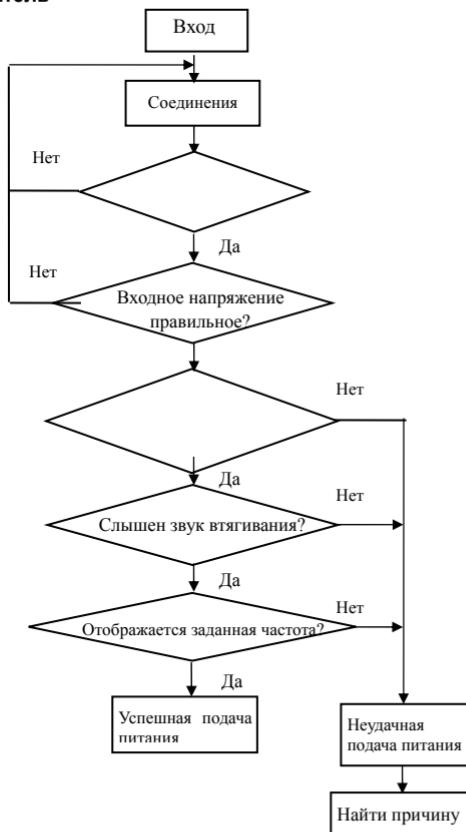
Рис. 4-11 Алгоритм операций, выполняемых при первоначальной подаче электропитания на преобразователь
