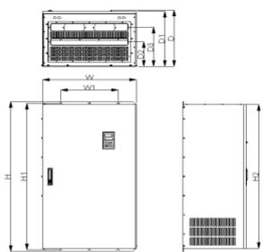
(г): мощностью 160 кВт ~ 200 кВт(кабинетных) (х): мощностью 160 кВт ~ 200 кВт(кабинет)
