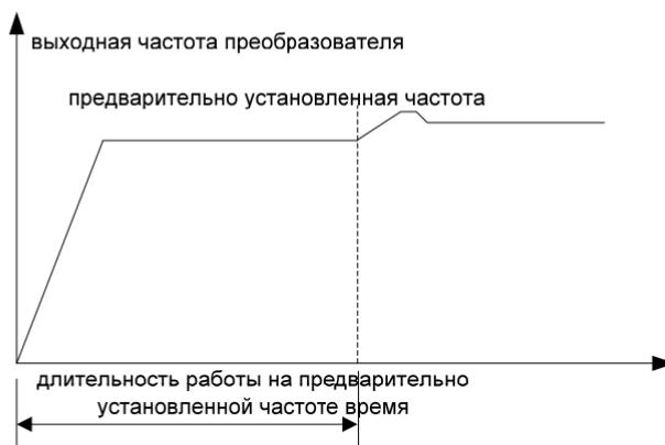
Рис. 6-24 Работа на предварительно установленной частоте
