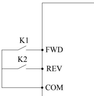
Рис.6-12 Режим управления двухпроводной линией 2
