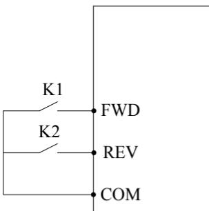
Рис.6-11 Режим управления двухпроводной линией 1
