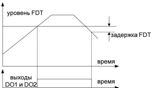
Рис.6-16 Установка уровня и задержки FDT (определения частоты)
