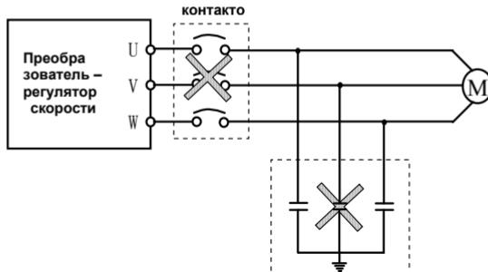
Рис. 1-3 На выходе преобразователя не допускается установка конденсатора
