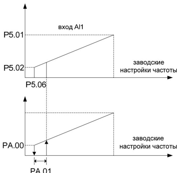
Рис. 6-33 Гистерезис на нулевой частоте
