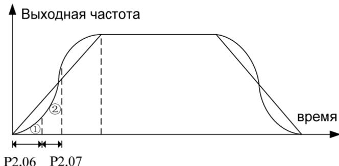
Рис. 6-7 Ускорение и замедление по S-образной кривой
